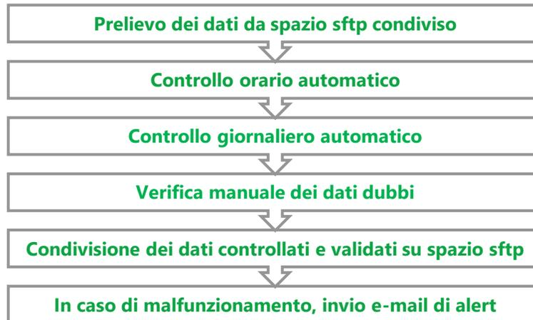
Fig. 18 Schema di flusso del processo di controllo, validazione e alert
